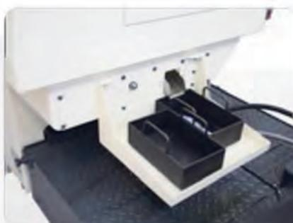
Деталь выгружается с помощью захвата из станка в специальный отсек, что позволяет, не останавливая работу станка, проверить качество и проконтролировать размеры готовой детали.
