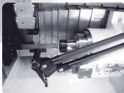
Захват для выгрузки деталей управляется путём выполнения на станке соответствующей M-функции. С помощью захвата детали можно выгружать из главного шпинделя или из контршпинделя в соответствии с технологией обработки детали. Захват можно использовать для деталей длиной не более 175 мм. Детали большей длины можно удалить путём проталкивания через отверстие в противошпинделе. Захват можно использовать для деталей разных типов.
